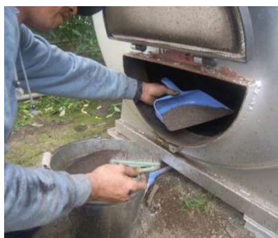
木質バイオマス暖房機の燃焼灰の清掃
