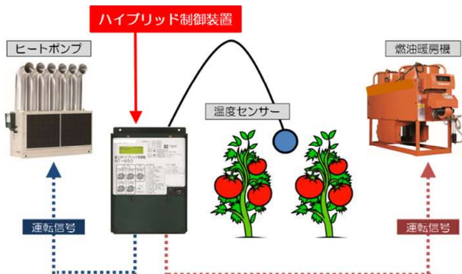
ハイブリッド制御装置による温度管理
