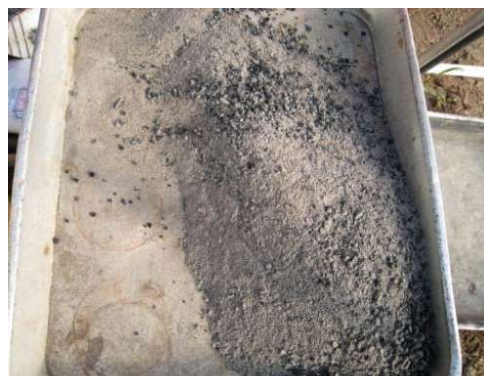
木質ペレットの燃焼灰
