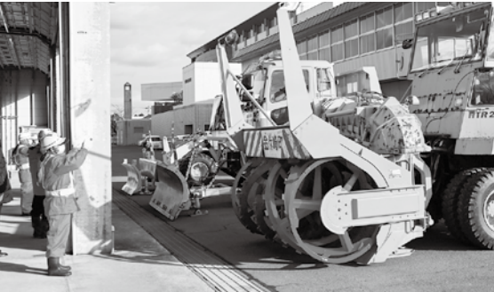
除雪車両を点検する作業員
