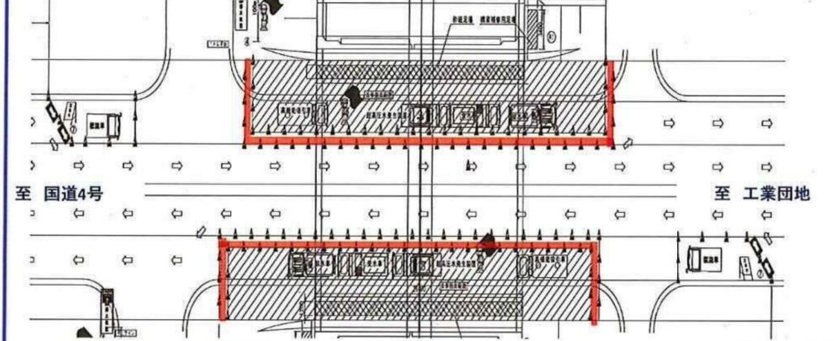
・車道中央側規制時(車線規制が片側だけの場合は、規制していないほうは夜間と同じ歩道位置)
