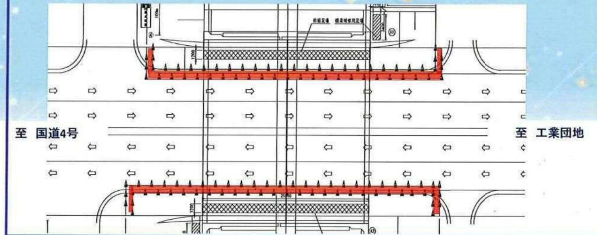
・車道路肩側規制時(車線規制が片側だけの場合は、規制していないほうは夜間と同じ歩道位置)
