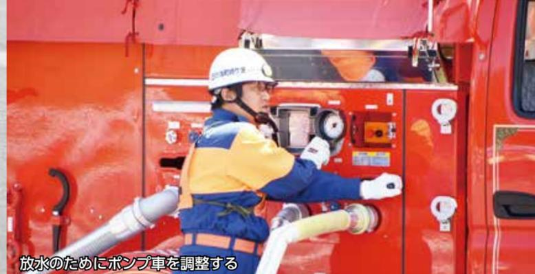
放水のためにポンプ車を調整する
